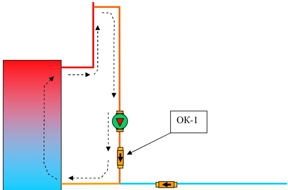
Неправильная схема рециркуляции горячей воды из за отсутствия обратного клапана OK-1 и при этом будет идти подмес холодной воды на разбор ГВС.
