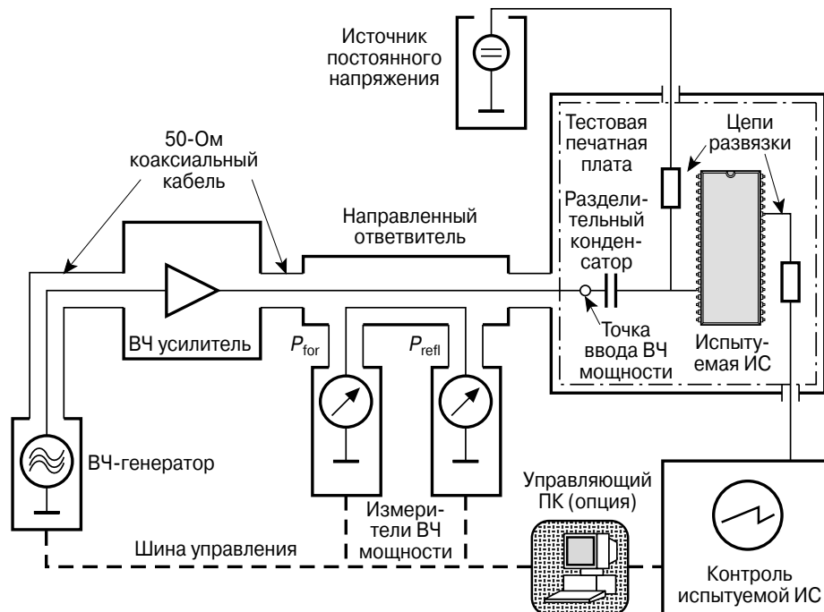
Рис. 13.19. Схема испытаний для измерения помехоустойчивости методом прямого введения мощности.
