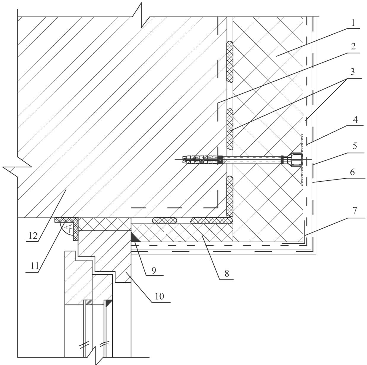
Рис. 25. Пример устройства теплоизоляции по откосу оконного проёма.
