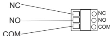
Зажимы для подключения проводов находятся на тыльной стороне приемника RX под крышкой и обозначены соответственно: NC, NO и COM. Это выводы контактной группы на переключение двухполюсного исполнительного реле (с двумя устойчивыми состояниями). Обычно вывод NC не используется.
