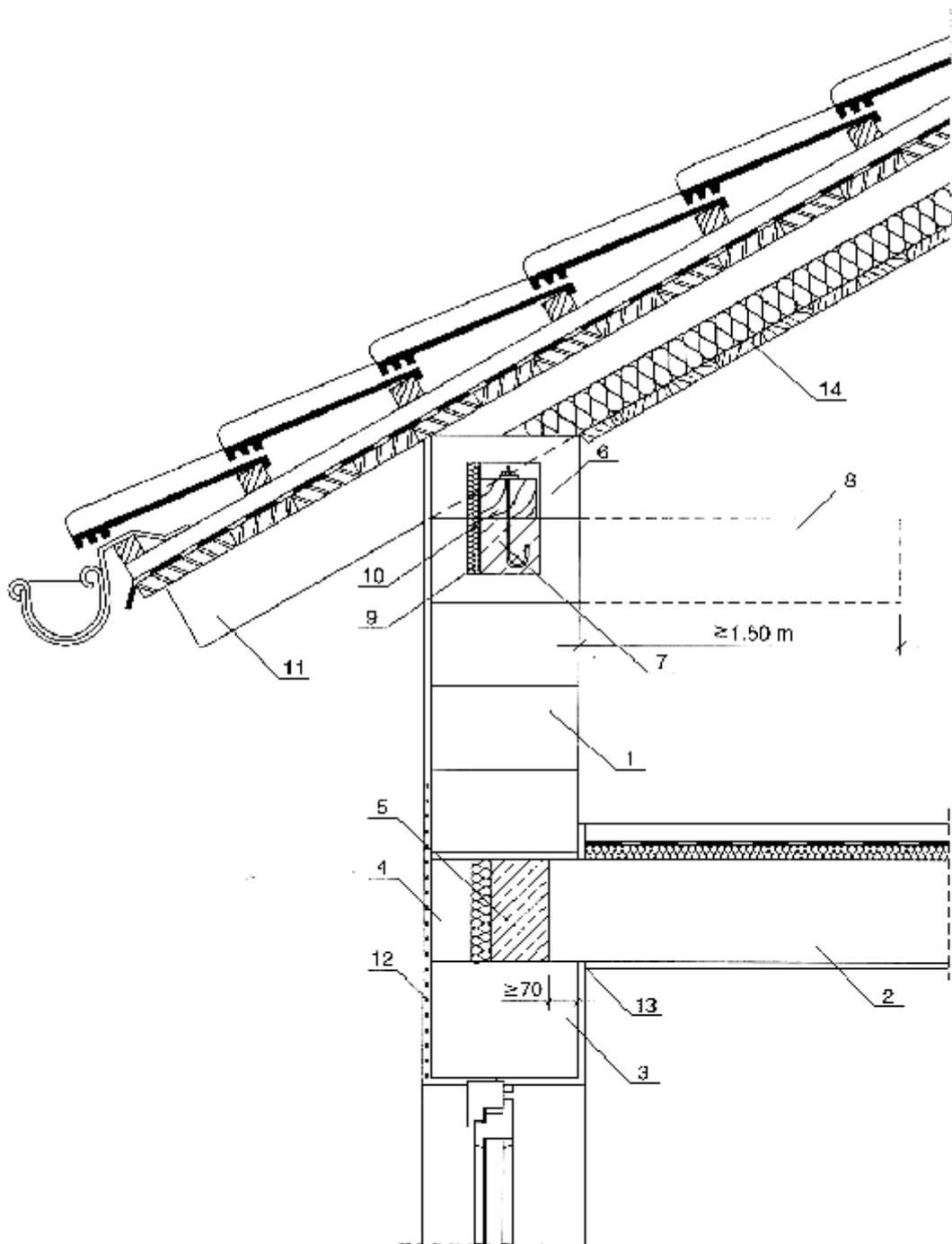
**Рис. 4.9 Крыша деревянной конструкции – опирание конструкции крыши на коленчатую стенку**
