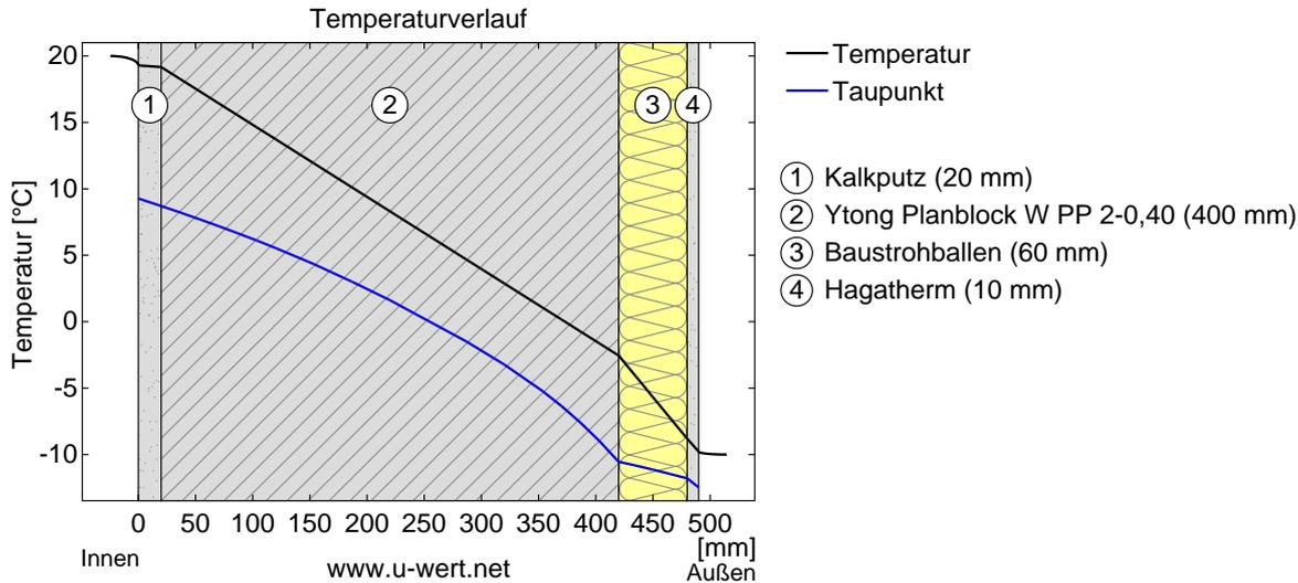
Verlauf von Temperatur und Taupunkt innerhalb des Bauteils. Der Taupunkt kennzeichnet die Temperatur, bei der Wasserdampf kondensieren und Tauwasser entstehen würde. Solange die Temperatur des Bauteils an jeder Stelle über der Taupunkttemperatur liegt, entsteht kein Tauwasser. Falls sich die beiden Kurven berühren, fällt an den Berührungspunkten Tauwasser aus.
