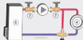
Повышение температуры на возврате в твердотопливный котел с Термостатической головкой К с контактным датчиком
