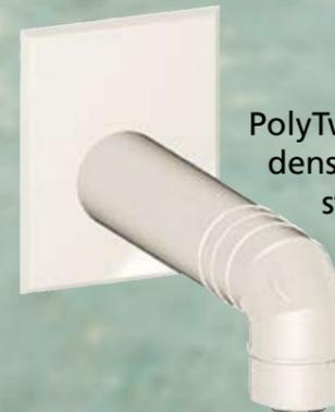
PolyTwin ist ein montagefertiges Abgassystem mit Innenrohren aus kondensatbeständigem Spezial-PP-Kunststoff und Zuluftrohren aus PP-Kunststoff (weiß). Korrosionsprobleme, Lochfraß und Metallablagerungen auf Dächern sind ausgeschlossen. PolyTwin Abgassysteme werden mit allem erforderlichen Zubehör für raumluftabhängige und -unabhängige Installationen in starrer und flexibler Ausführung für Schacht- und Außenwandmontage geliefert.
