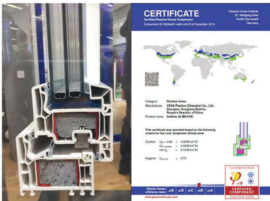
Рис. 3. Сертифицированная для пассивных домов в умеренно-холодной климатической зоне профильная система Veka Softline 82 MD PSR
