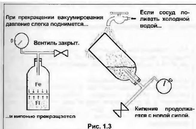
Когда вода полностью закипит, закроем изолирующий вентиль сосуда на выходе из него (см. рис. 1.3). Кипение полностью прекращается.
