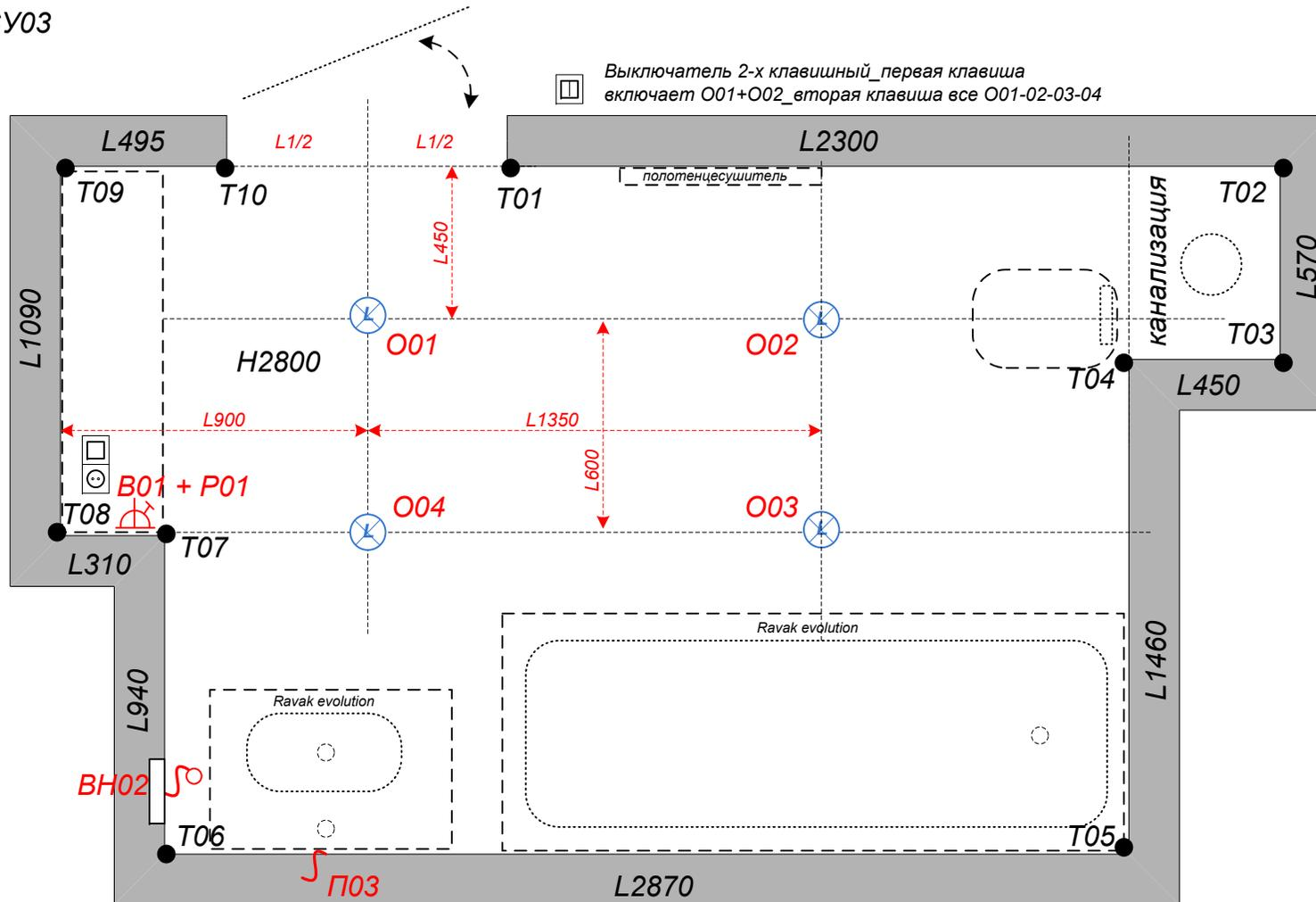
**B01 + P01** \_выключатель для вентилятора BH02 + розетка\_отступ от T07 122мм (внутри шкафа)
