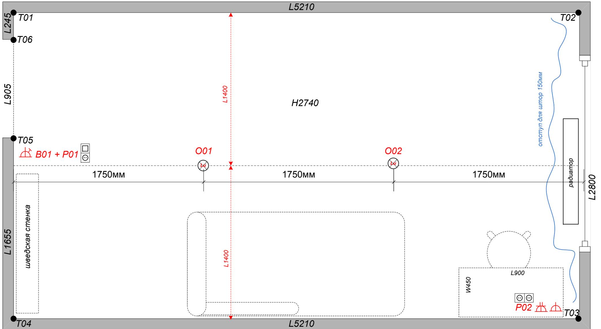
**B01 + P01** \_выключатель + розетка (проем01-06\_вход в детскую)\_отступ от T05 – 202мм (отступ от наличника (W80мм) до рамки 80мм) **P02** \_розетка 3шт. – отступ от T03 450мм
