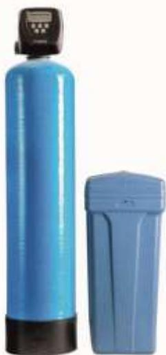
Фильтры серии СTF-CRF предназначены для комплексной очистки воды: снижения жесткости (удаление солей кальция и магния), а также для удаления железа, марганца и природной органики из воды, используемой для подпитки паровых и водогрейных котлов, систем охлаждения, в системах хозяйствственно-питьевого водоснабжения, на предприятиях с непрерывным циклом производства.
