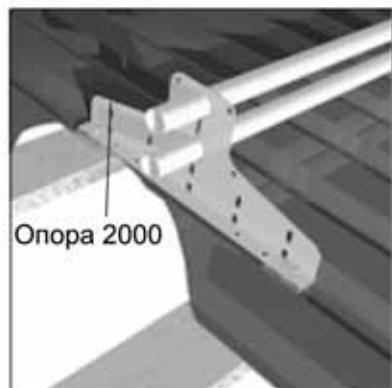
Болтовые отверстия уплотняются резиновыми прокладками, вставляемыми между опорой и кровельным покрытием. На фигурные кровельные плиты под нижний конец опоры вставляются по две прокладки.
