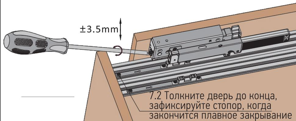
7.2 Толкните дверь до конца, зафиксируйте стопор, когда закончится плавное закрывание
