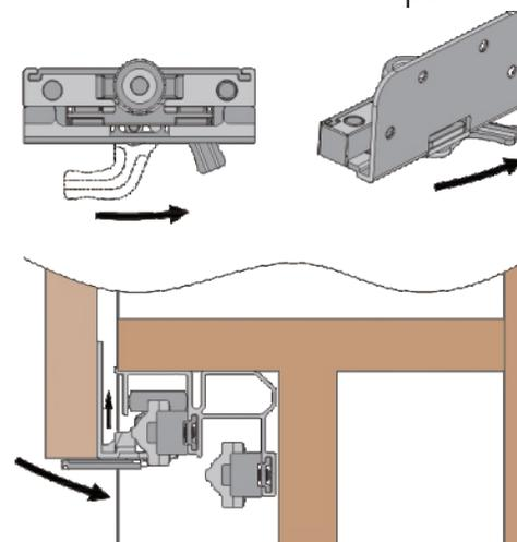
Поверните рычажок нижнего ролика против часовой стрелки. Таким образом нижний ролик поднимется в нижнюю рельсу
