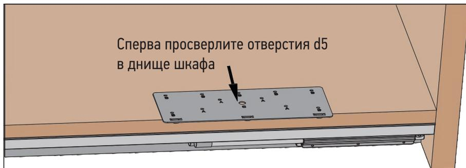
Установка нижней направляющей, вариант 1
