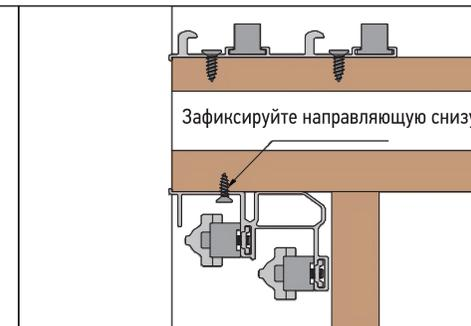
Зафиксируйте направляющую снизу
