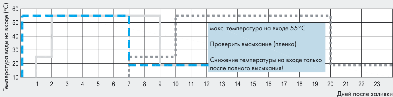
Схема отопления – Наливной монолитный пол на водяном отоплении
