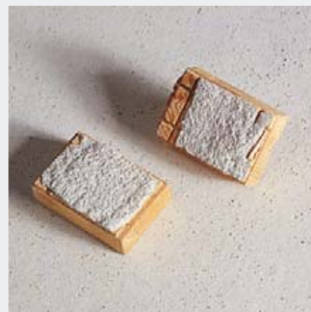
Разлом в месте отрыва паркета от пола
