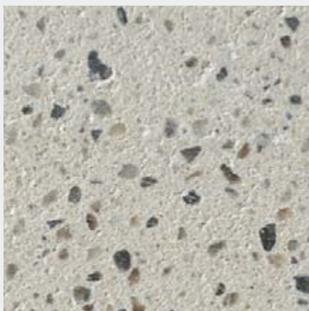
Поперечное сечение монолитного пола КНАУФ, увеличение в 4 раза
