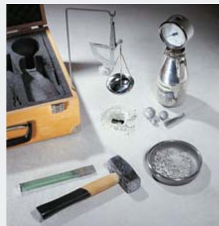
Определение готовности к укладке покрытия прибором СМ
