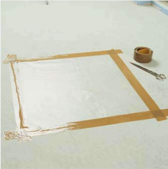
Контроль высыхания при помощи пленки на монолитном полу с отоплением
