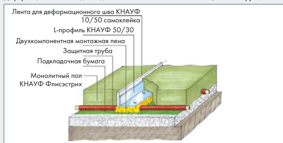
Деформационный шов здания для монолитного пола с отоплением, тип конструкции А
