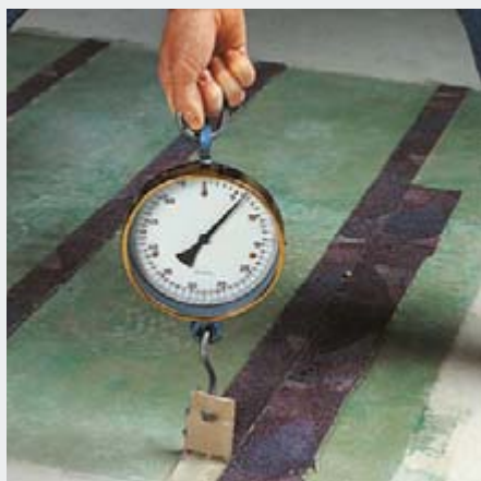
Пробное приклеивание и проверка сопротивления покрытия на отрыв
