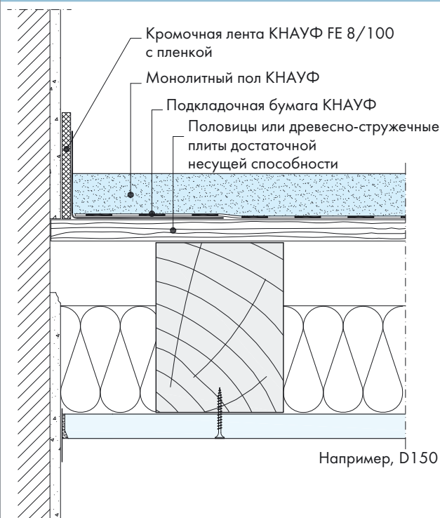
F221-V3 Оформление края на деревянном балочном перекрытии
