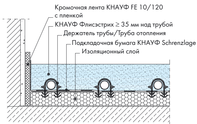
F233-V1 Оформление края на массивном перекрытии
