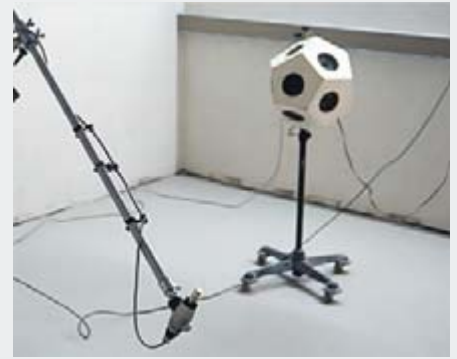
Измерение воздушного шума
