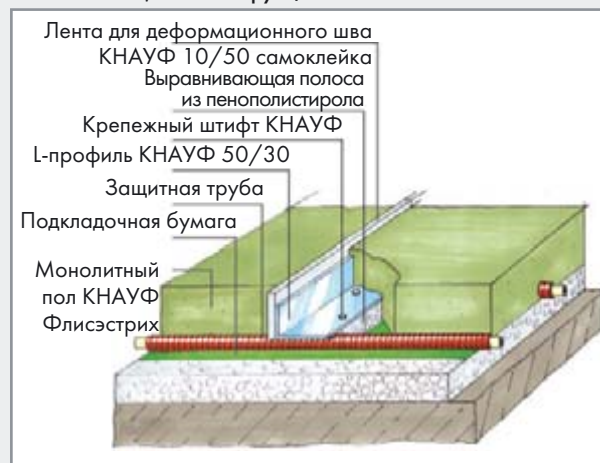
Деформационный шов здания для монолитного пола с отоплением, тип конструкции А
