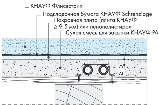
F231-V14 Выравнивание основания пола сухой смесью для засыпки КНАУФ РА
