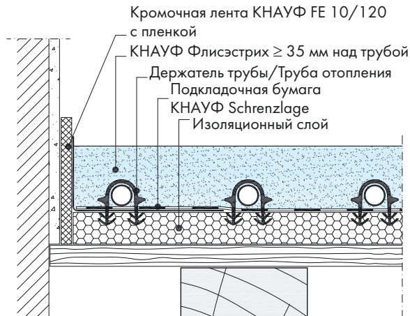
F233-V3 Оформление края на деревянном балочном перекрытии
