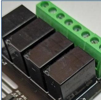
Для керування виходами використовуються високоякісні реле із номінальним струмом 10А та із пусковим струмом до 80А.
