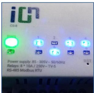
Індикація живлення, стану виходів та відображення зміни стану входів (короткочасне увімкнення індикатора обміну даними) дає змогу візуально спостерігати за роботою пристрою.
