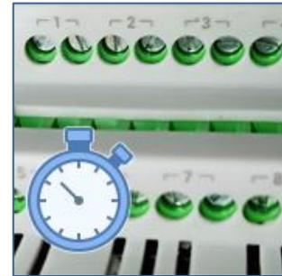
При відключення живлення стан обраних виходів зберігається в енергонезалежній пам'яті для відновлення при подачі живлення.
