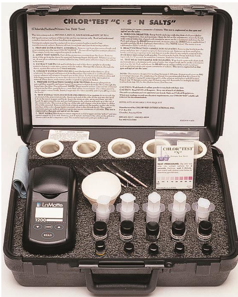
Рисунок 9.43. – комплект Elcometer 134 CSN для комплексного тестирования содержания ионов хлоридов, сульфатов и нитратов.
