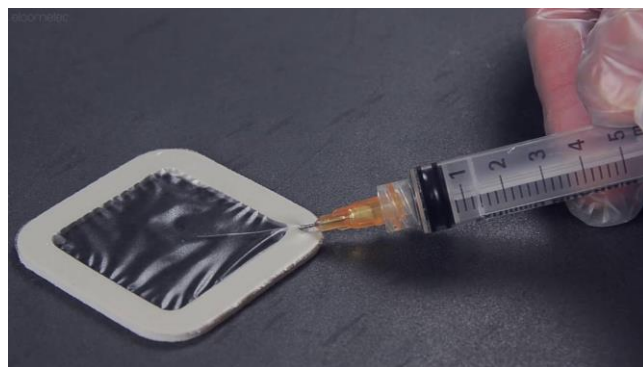
Рисунок 9.45. – Введение дистиллированной воды под пластырь.
