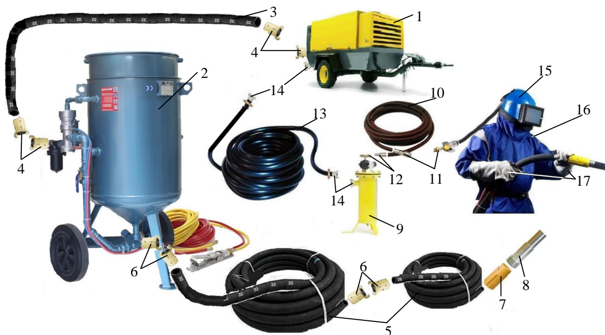
Рисунок 9.77. – Типовой комплект абразивоструйного оборудования.
