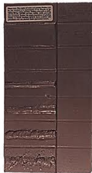
Рисунок 9.37. – Компаратор поверхности сварного шва.
