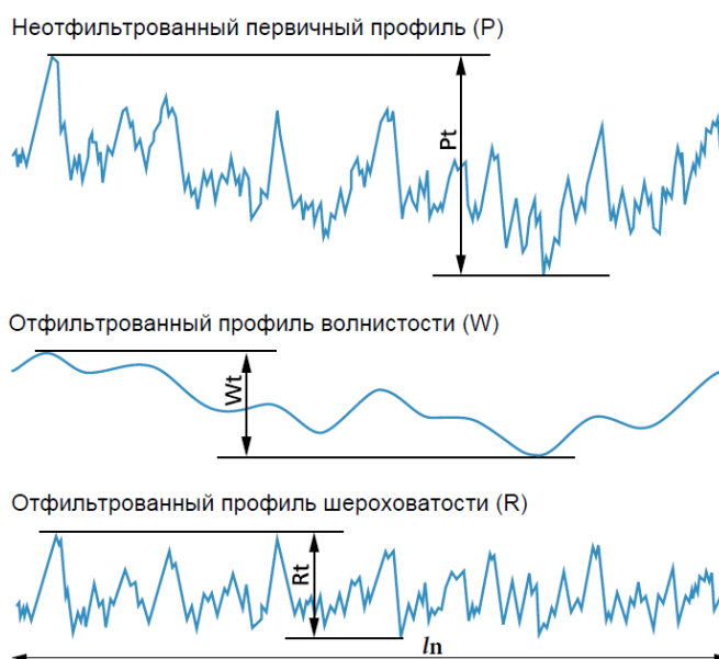
Рисунок 9.115. – Типы профилей поверхности: P_t , W_t и R_t – общая высота соответственно для первичного профиля, профиля волнистости и шероховатости на полном отрезке измерения; l_n – длина оценки (evaluation length).
