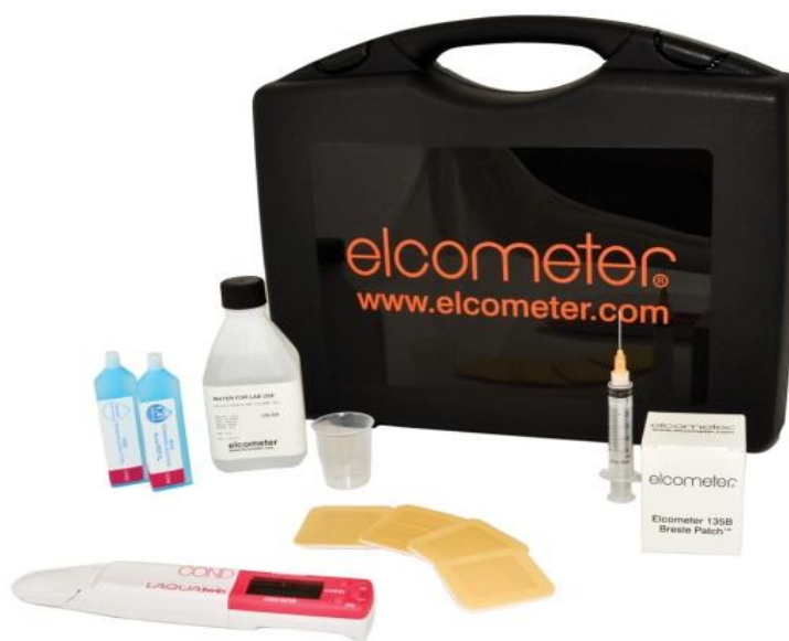
Рисунок 9.44. – Набор Бресла с пластырями для измерения загрязненности солями Elcometer 138.
