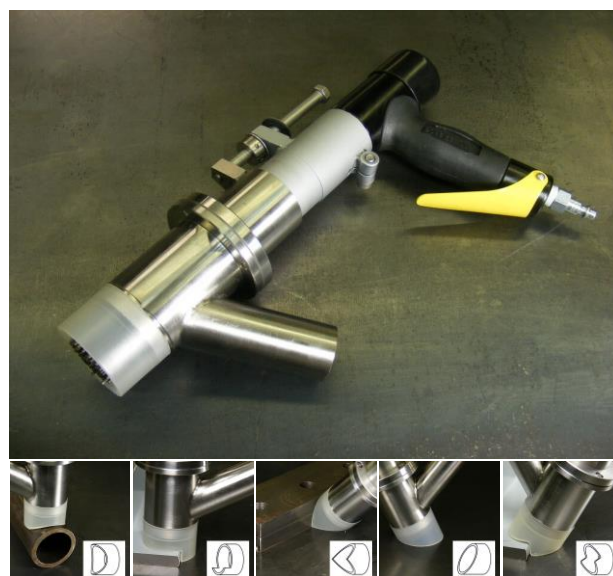
Рисунок 9.59. – Игольчатый пистолет Corner-Cutter с устройствами для отвода
