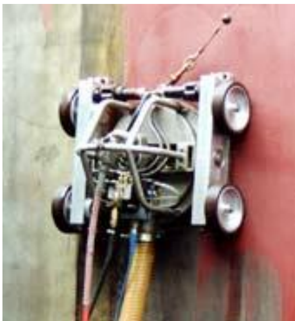
Рисунок 9.102 – Насадка для полуавтоматической очистки вертикальных поверхностей.
