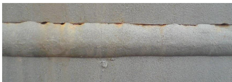
Рисунок 9.32. – Односторонний подрез сварного шва.
