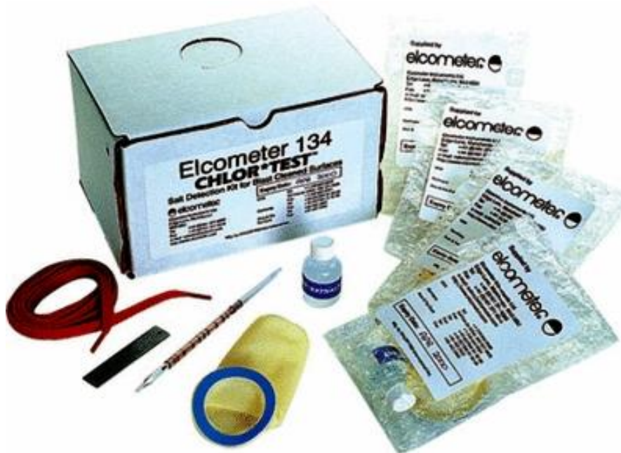
Рисунок 9.39. – Набор для определения хлорид-ионов по стандарту ISO 8502-5 Elcometer 134 S.
