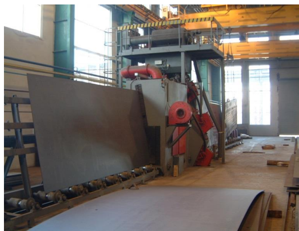
Рисунок 9.91. – Проходная дробеметная стационарная установка.
