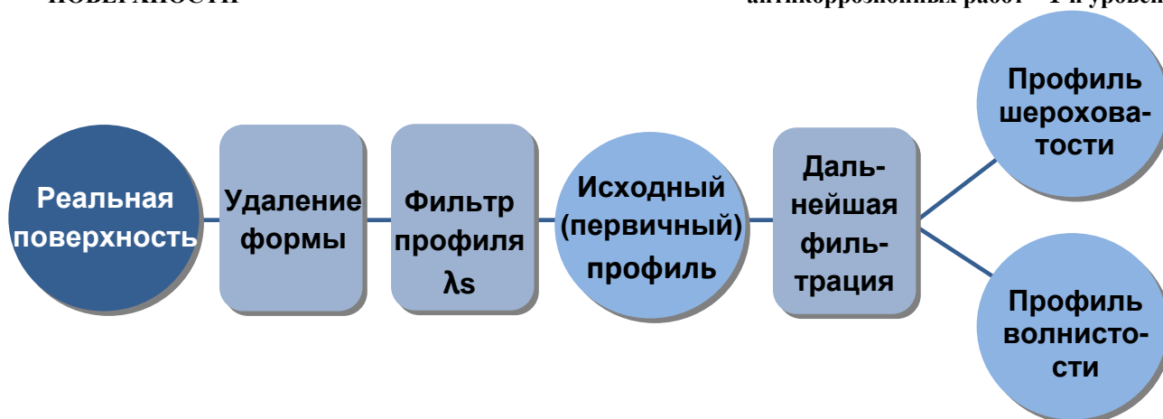
Рисунок 9.114. – Блок-схема оценки профиля шероховатости поверхности.
