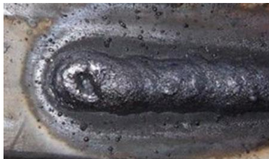
Рисунок 9.34. – Кратер сварного шва.
