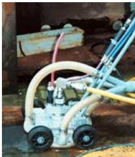
Рисунок 9.103. – Насадка для очистки горизонтальных поверхностей.
