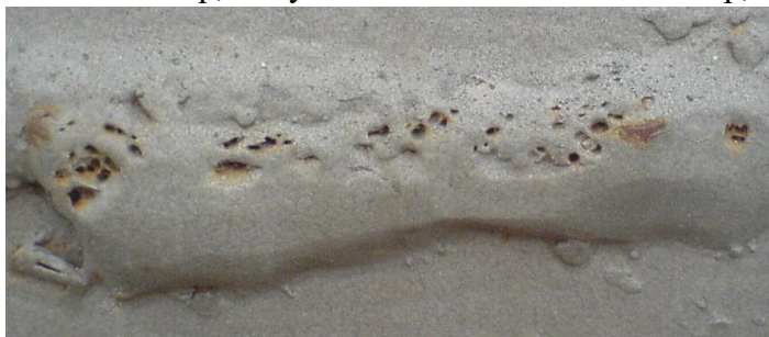
Рисунок 9.33. – Поверхностные поры сварного
