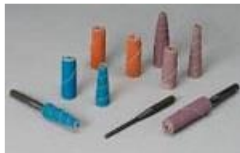
Рисунок 9.64. Абразивные шлифовальные головки.
