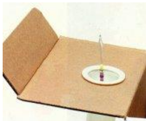
Рисунок 9.42. – Измерение концентрации солей раствора титровальной трубкой.
