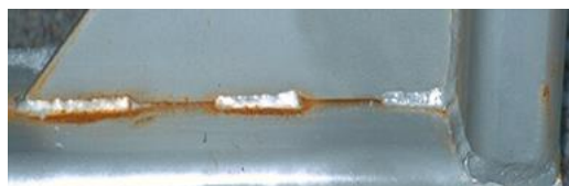
Рисунок 9.29. - Прерывистый сварной шов внахлест.
