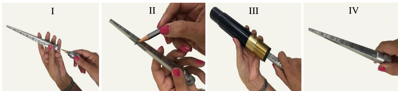
Рисунок 9.86. – Способ применения прибора для контроля диаметра сопла: I, II, III, IV – последовательность применения прибора.
