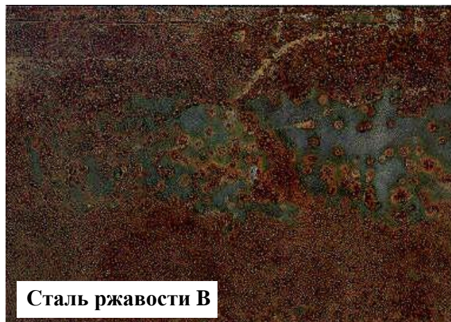
Рисунок 9.74. – Сталь ржавости В по SSPC.
