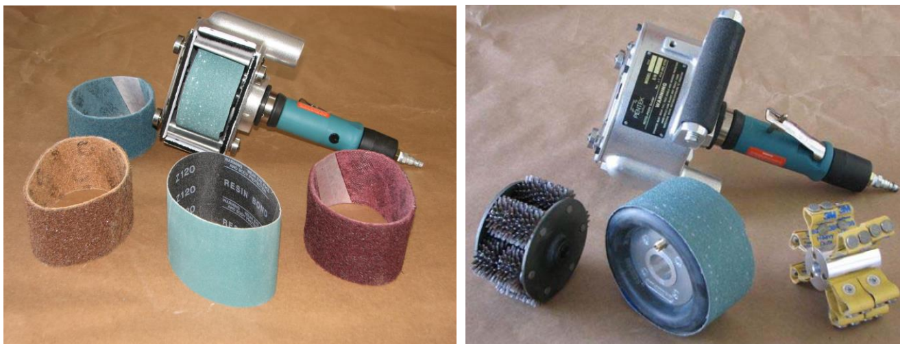
Рисунок 9.65. Шлифмашина Roto-Peen с мягкими амортизирующими шлифовальными кругами.
