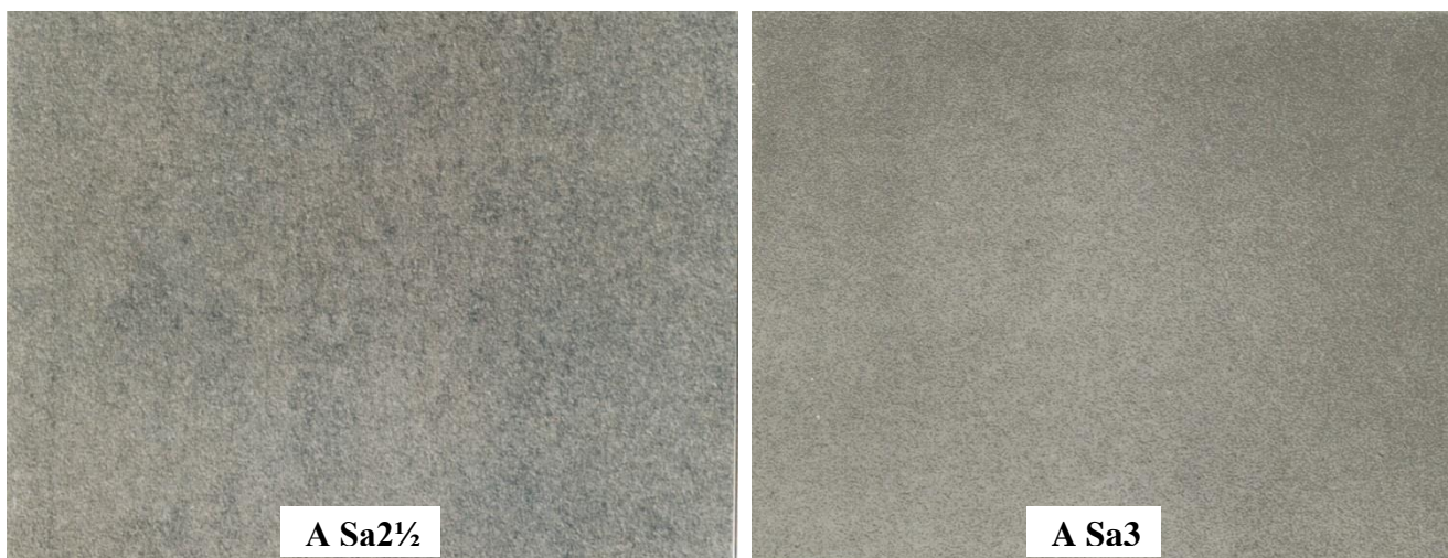
Рисунок 9.69. – Очищенная абразивоструйным способом сталь ржавости А.
