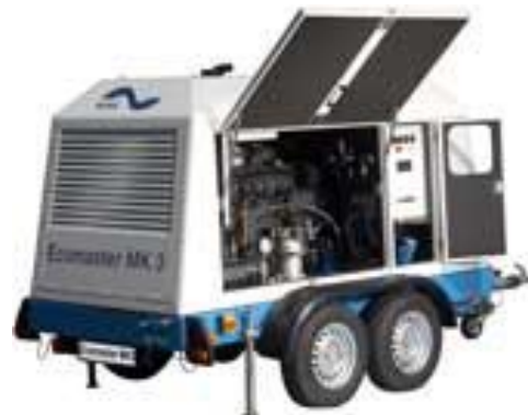
Рисунок 9.97. – Мобильная установка сверхвысокого давления.
