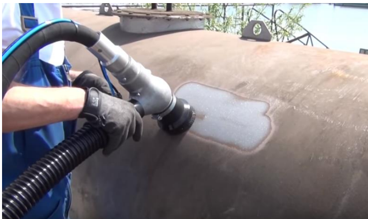
Рисунок 9.94. – Вакуумный дробеструйный аппарат.
