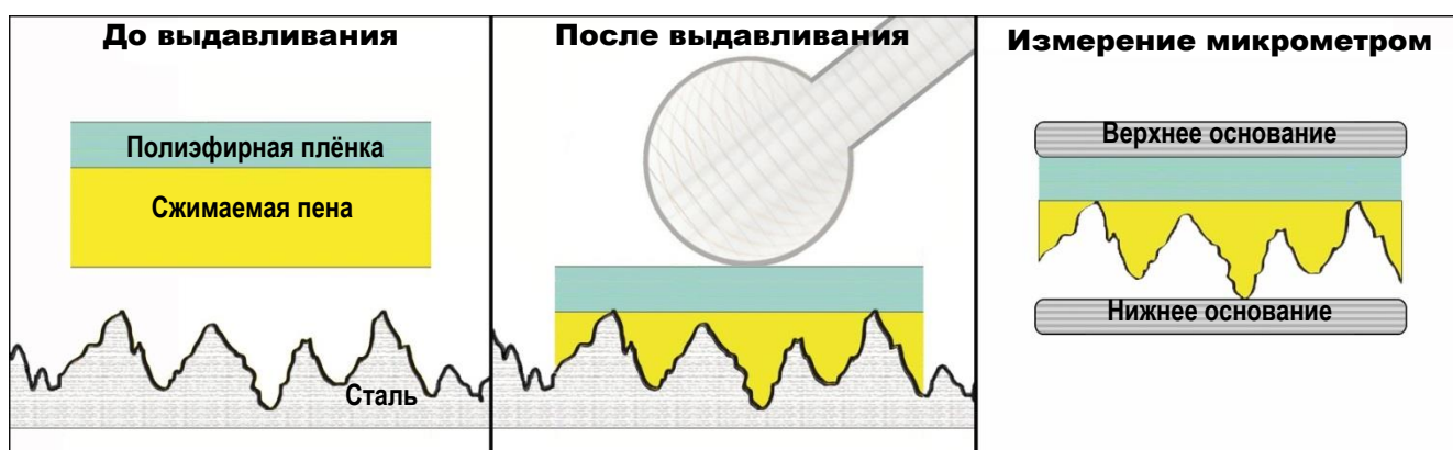
Рисунок 9.125– Метод измерения шероховатости с помощью ленты-реплики.
