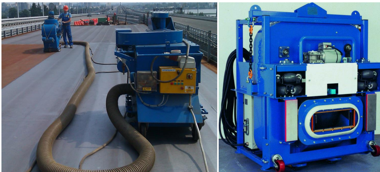
Рисунок 9.93 – Мобильные дробеметы для очистки горизонтальных (слева) и вертикальных (справа) плоских поверхностей.
