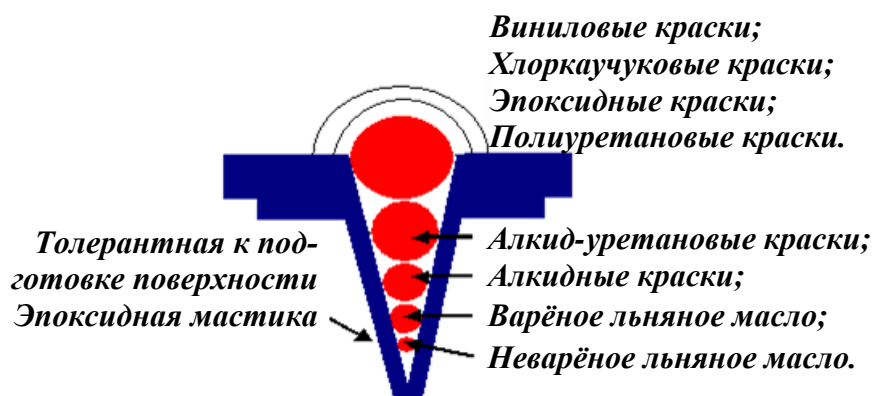
Рисунок. 5.6. – Сравнение проникающей способности различных типов красок.
