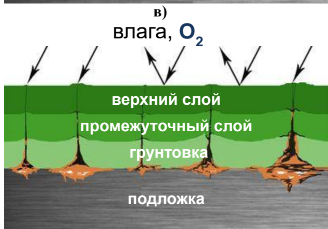
Рисунок 5.8. – Схема взаимодействия нанесенного покрытия с влажной подложкой.
