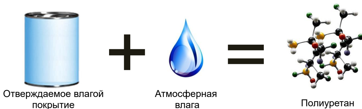
Рисунок 5.9. – Механизм полимеризации отверждаемых влагой полиуретанов.
