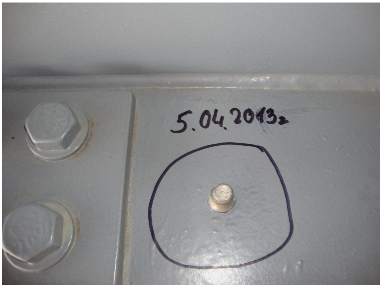
Рисунок 7.10. – Приклеивание грибка на место проведения испытаний.
