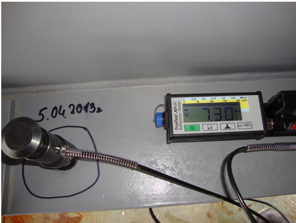
Рисунок 7.12. – Измерение адгезии адгезиметром PosiTest AT-M.
