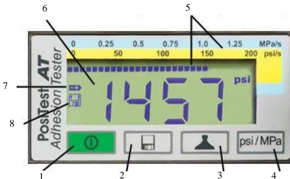
Рисунок 7.8. – Общий вид пульта управления PosiTest AT-M:
