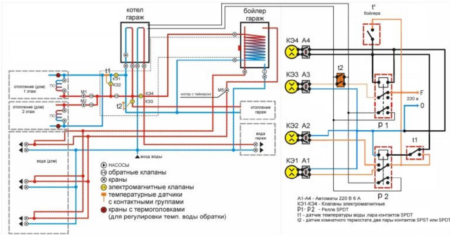
При остывании бойлера замыкается термостат  $t^*$  бойлера при этом открывается КЭ-4 и КЭ-2, КЭ-1 и КЭ-3 закрываются, P-1 включает котёл и бойлер нагревается.
