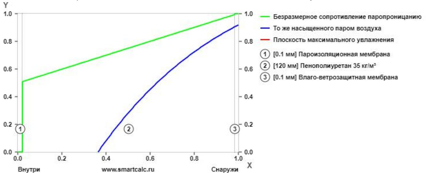
Координата плоскости максимального увлажнения X 0.00 мм
