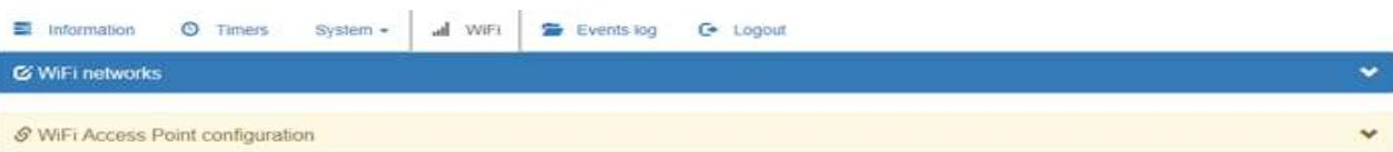
Первый элемент меню “**WiFi Networks**” отвечает за конфигурацию контроллера в режиме клиента (подключенного к точке доступа). Второй элемент меню – это конфигурация встроенной точки доступа (Access point).
